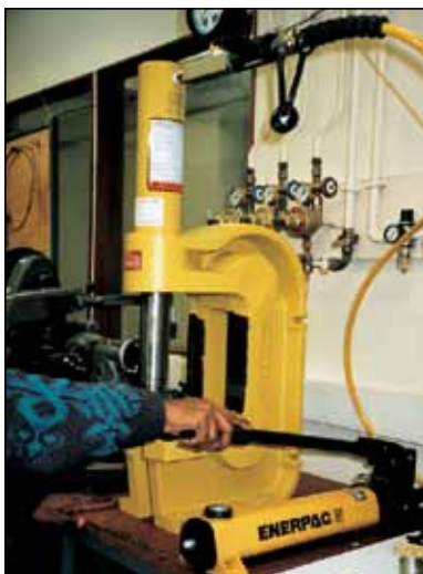
◀ Prensa Abor A-310 utilizada para compactar polvo a 10 toneladas.
